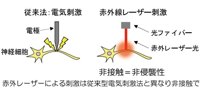
赤外レーザーによる刺激は従来型電気刺激法と異なり非接触で神経を刺激可能。
