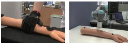
ヒトのタッチケア動作のデータ化と「ロボット」による再現
